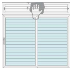
Tampa aberta para limpeza externa da persiana.
